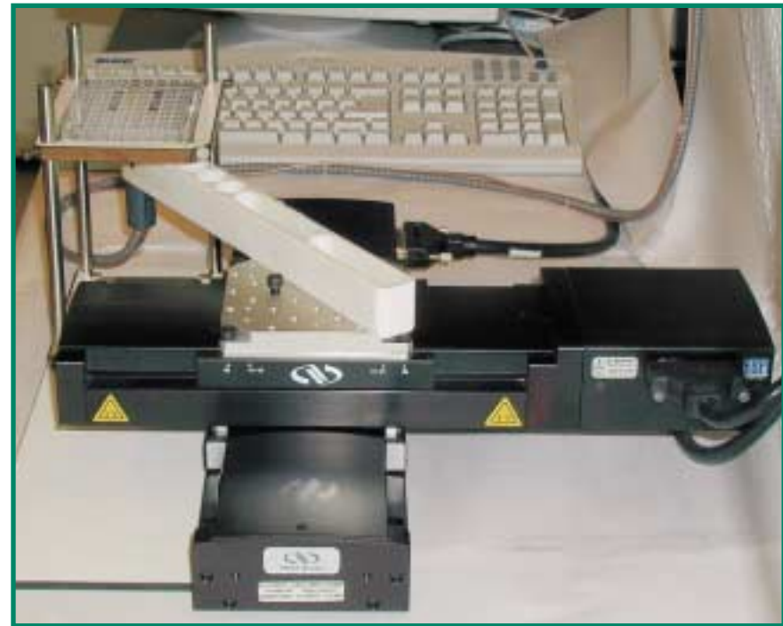
Zuurstofmeting voor zaden is geautomatiseerd. Een robotarm tast de afzonderlijke cellen met de zaadjes stuk voor stuk af. De meetgegevens worden doorgesluisd naar een computer met speciale software.
