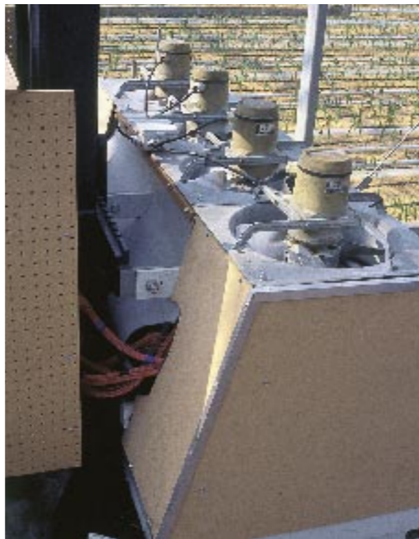
De speciale magnetronbuizen zijn gemonteerd in een bak. De ventilatoren zijn voor koeling van de buizen. De opbouw is nog in de prototypefase.
