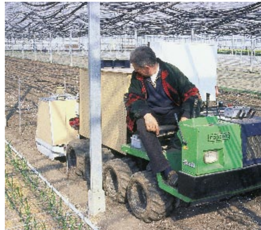
De magnetronbak is gemonteerd aan een trekker, hier bestuurd door Aad Middelburg. Gezocht wordt nog een lichter trekkertype.
